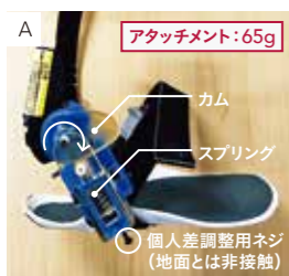
図A: 開発したバネ・カム機構を有するデバイス(写真は右足用)。AFO (Gait Solution; Pacific Supply Co., Ltd., Japan) が480gに対して、研究グループが開発したアタッチメントは65gと超軽量かつモーターレス。中央下部に見えるネジ(地面とは非接触)で、個人の脚力に応じた調整が可能。
