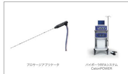
図1. 実用化予定の医療機器・医療材料・体外診断装置の概要 RF(ラジオ波)焼灼用針(プロソーシアアプリーケーター)、送水ユニット、電源装置からなるバイポーラタイプのRFアブレーションシステム(バイポーラRFAシステム CelonPOWER)であり、バイポーラタイプ電気メスとはほぼ同じ技術の応用で先頭に第1・第2電極を有し、300~500kHzの高周波電流、40W程度の電力で副腎腺腫組織の焼灼を可能とする
